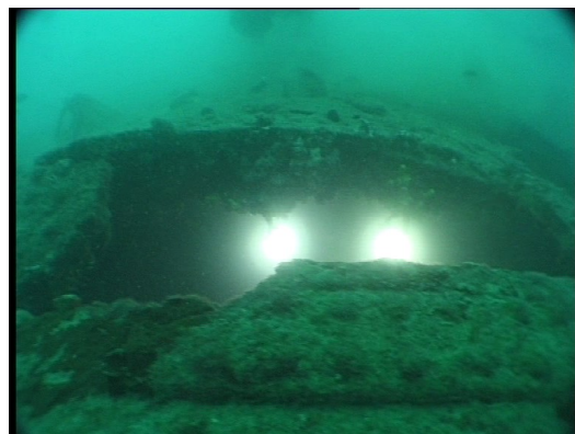
Allegato n° 25 varco sullo scafo resistente tagliato a fiamma
