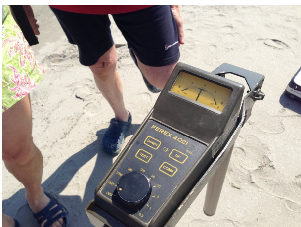
Fig. 24 il magnetometro Ferex 4.021, certificato per bonifiche militari sta rilevando un buon segnale
