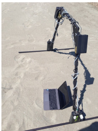
Fig. 23 georadar a dipolo Sors Oerad Pro
