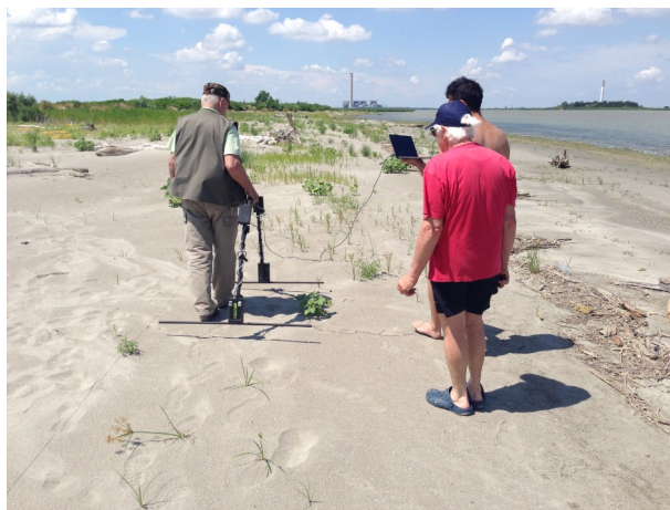
Fig. 24 georadar/scanner con capacità di penetrazione fino a m 20
